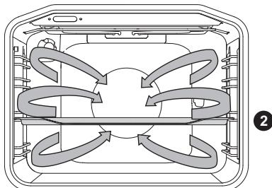
При тази функция ще работят кръговият нагревател и вентилаторът. Монтираният на задната стена на фурната вентилатор осигурява равномерна циркулация на горещ въздух около ястието или тестените изделия.
